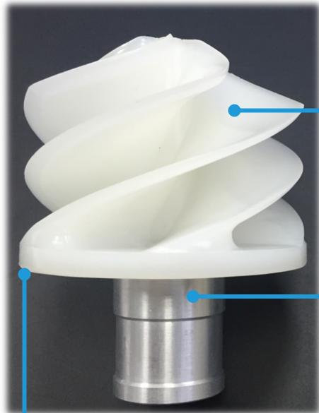
Spritzgießbauteil, hergestellt durch ein 6-teiliges Werkzeug1
